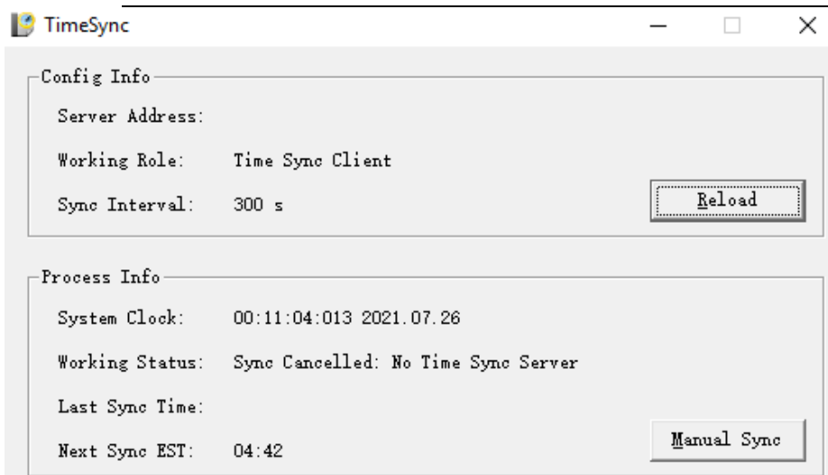
Рисунок 9-7. Интерфейс, когда резервный сервер синхронизации времени работает как клиент синхронизации времени
