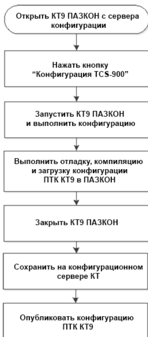
Рисунок 6-1 конфигурация системы КТ9
